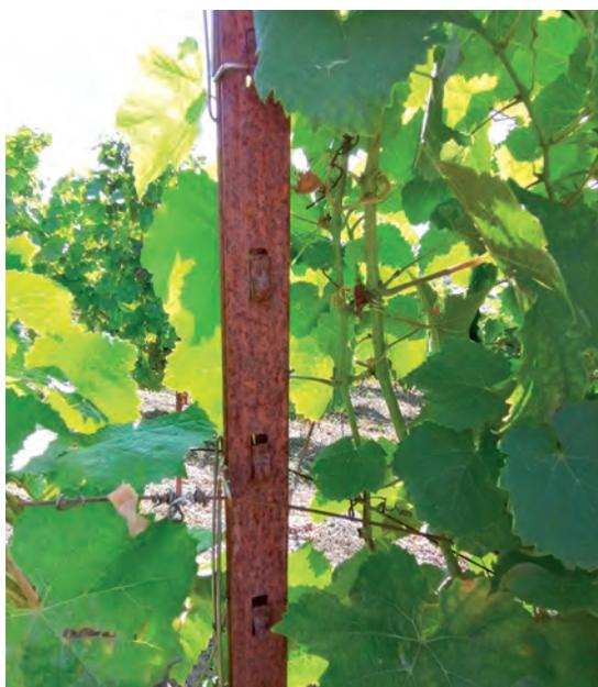
L'**acier auto-patinable**, également connu commercialement en Espagne sous le nom de **Corten** ou **Cor-ten**, **COR-TEN** ou **ENSACOR**, est un type d'acier dont la composition chimique lui confère une oxydation aux caractéristiques particulières qui protègent la pièce fabriquée avec ce matériau contre la corrosion atmosphérique.
